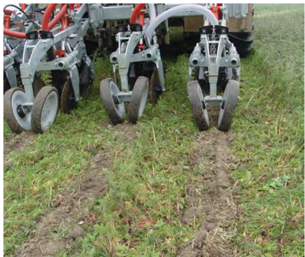
Abbildung 70: Streifenlockerung (Strip-Tillage) mit Gülle-Unterflurdüngung (Quelle: TLL)
