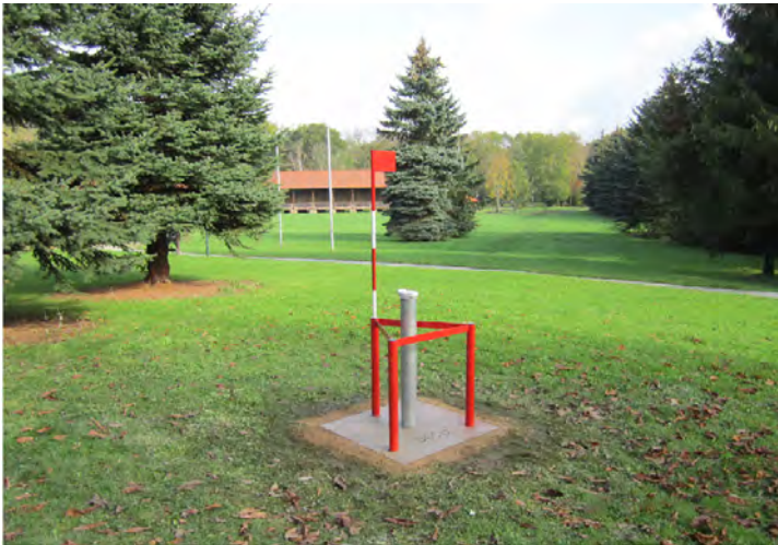
Abbildung 32: Grundwassermessstelle in Bad Sulza mit Anfahrschutz und Sichtstange (Quelle: ThLG)
